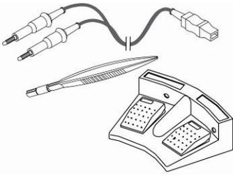
**Una pinza bipolare (opzionale) e pedale doppio (opzionale):** Collegare il cavo ed l'accessorio bipolare (opzionali) (vedi pag. 4). Erogare la corrente premendo il pedale associato alla coagulazione (blu). Per non danneggiare la pinza non cortocircuitarne le punte.
