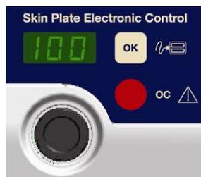
Se il valore di impedenza è accettato, è recepita l'indicazione dell'impedenza e il display e l'indicatore OC sono stabilmente spenti. Se dopo aver accettato l'impedenza mostrata, il valore di questa aumenta relativamente al valore accettato, l'apparecchiatura impedisce l'erogazione, indica la condizione OC, priva di segnale acustico (presente solo durante l'erogazione) e mostra il nuovo valore di impedenza. Per accettare questo nuovo valore premere il tasto OK.
