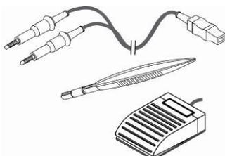
**Una pinza bipolare (opzionale) e pedale singolo:** Collegare il cavo ed l'accessorio bipolare (opzionali) (vedi pag. 4). Erogare la corrente premendo il pedale. Per non danneggiare la pinza non cortocircuitarne le punte.
