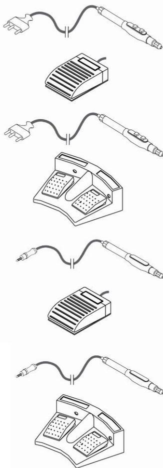
**Un manipolo con due pulsanti e il pedale singolo:** impostare tramite i tasti di selezione sull'apparato tra taglio CUT, BLEND o ENHANCED e coagulazione FORCED COAG o SOFT COAG, preselezionare, tramite tasto giallo del manipolo, la funzione di taglio selezionata sull'apparato o preselezionare, tramite tasto blu del manipolo, la funzione di coagulazione selezionata sull'apparato. L'emissione avviene tramite pedale.
