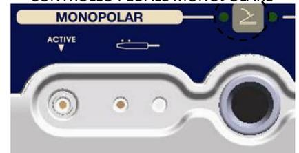
**Nota:** PER L'USO DEL PEDALE è necessario selezionare il controllo pedale per monopolare. Accensione spia corrispondente.
